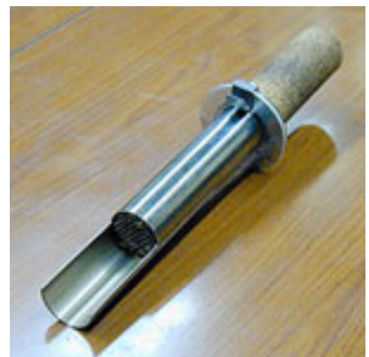
排気検査機能付スプーン 排気の状態が チェックできる
